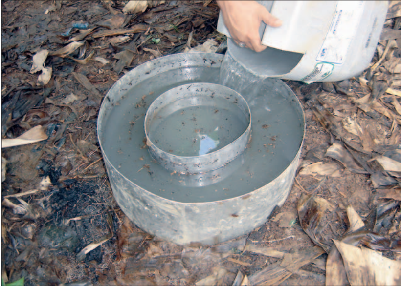
Figura 5. Prueba de infiltración mediante el método de doble anillo.
