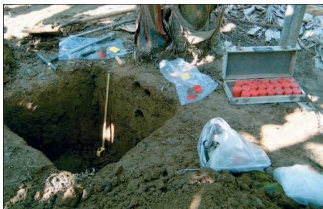
Figura 3. Muestreo de densidad aparente en la banda de fertilización usando una minicalicata.
